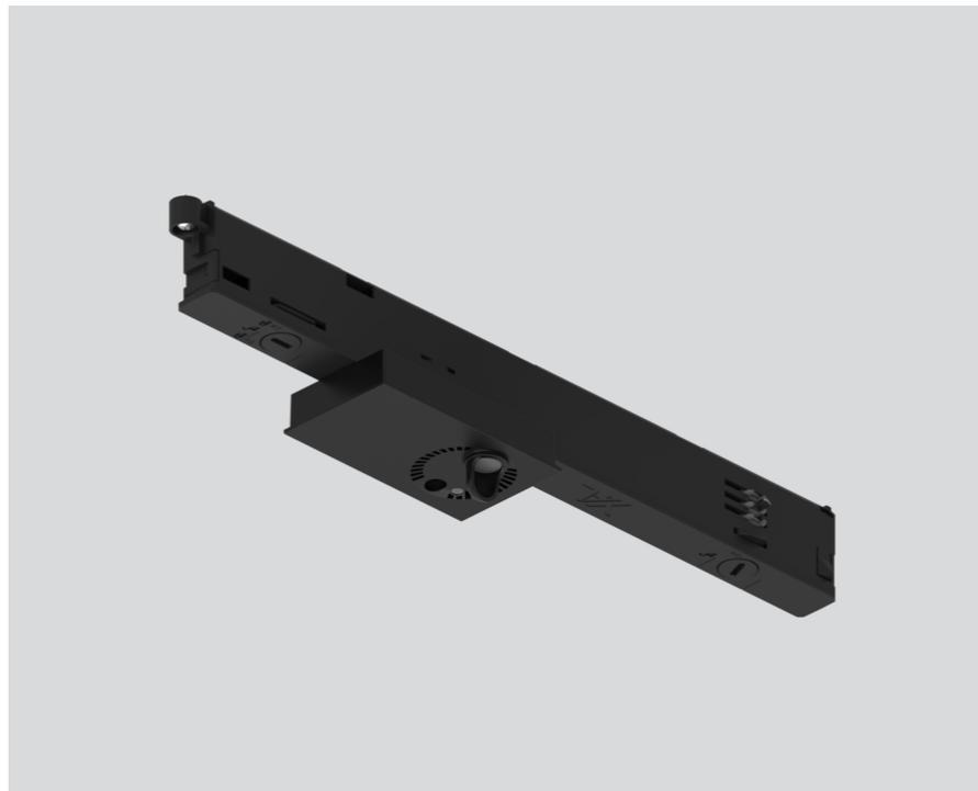
Inserto de sensor; SENSE (sensor de luminosidad, presencia, temperatura, humedad/calidad del aire y nivel de ruido); para sistemas de iluminación; superficie negro intenso; inserto puede instalarse de un modo flexible y sin herramientas; enrasado en el sistema de perfiles; grado de protección IP20; CP3; 9,5-22,5V; control con DALI-2;
