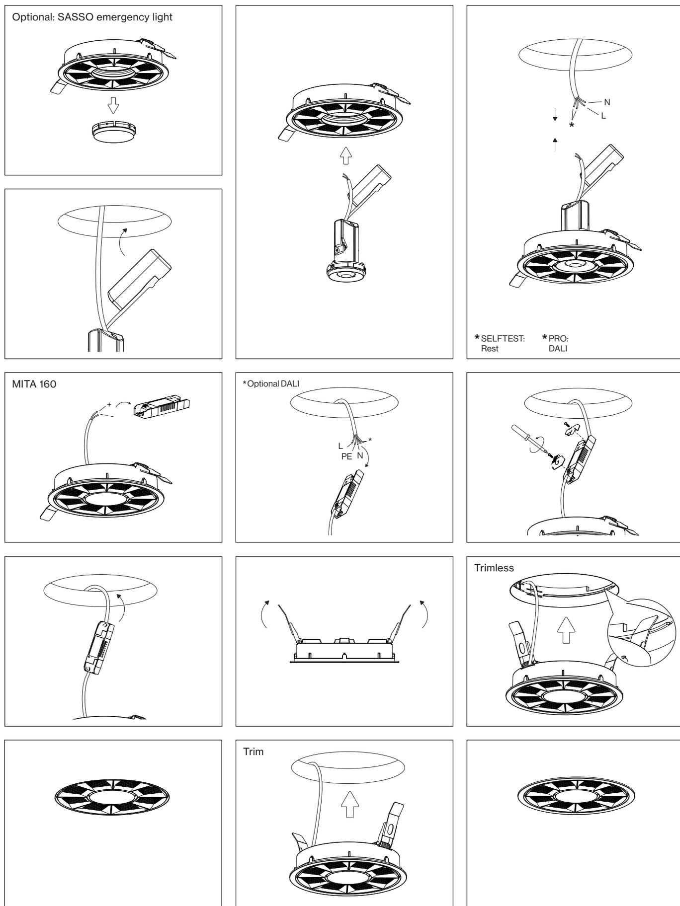
**DE** Die Demontage erfolgt sinngemäß in umgekehrter Reihenfolge der Montage.
