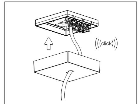
**DE** Die Demontage erfolgt sinngemäß in umgekehrter Reihenfolge der Montage.
