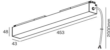
**DE** Nicht kompatibel mit dem Indirekt-Channel der Länge 610 mm!
